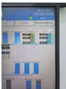
Foto 1 - Visualização do nível dos reservatórios Nações no CCO, através de telemetria.
