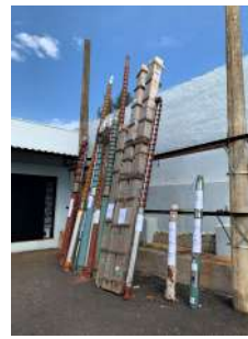
Foto 14 - Estoque de bombas reservas dos poços na ETA.
