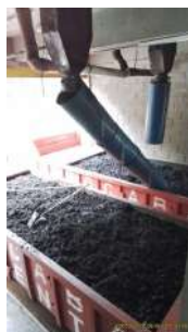
Foto 14 - Lodo acondicionado em caçambas.
