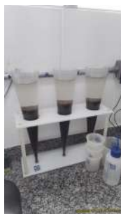
Foto 46 - Amostras dos reatores para verificar sólidos sedimentares nos reatores.
