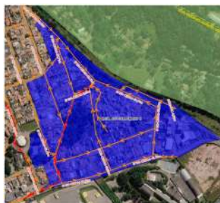
Foto 20 - Detalhe da bacia de contribuição de direcionamento do esgoto pela EEE Centenário II.
