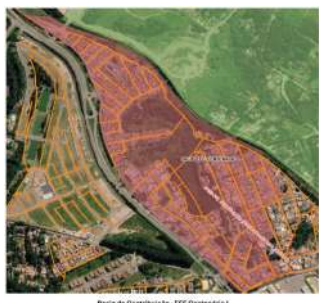
Foto 6 - Detalhe da bacia de contribuição da EEE Centenário I.
