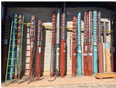
Foto 15 - Estoque de bombas reservas, inclusive do poço Cedrinho
