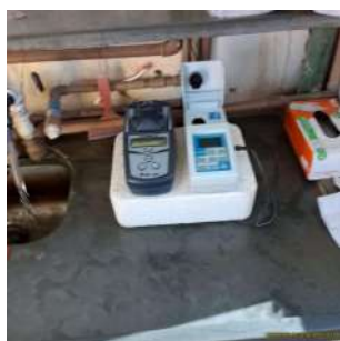
Foto 62 - Espectrofotômetros utilizados para as análises de cloro e flúor.
