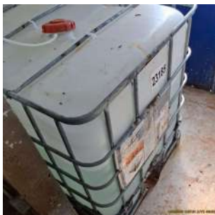
Foto 7 - Tanque de hidróxido de sódio. O reagente estava sendo utilizado em caráter de teste para eventual substituição do produto atualmente empregado.
