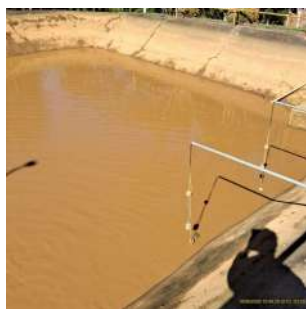
Foto 71 - Sensores de boia utilizados para o controle do volume armazenado.
