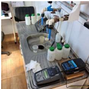
Foto 1 - Laboratório de análises físico-químicas. O espaço é reduzido, sendo realizadas apenas análises básicas, como cloro residual, pH e turbidez. As demais análises são realizadas no laboratório da ETA Central.
