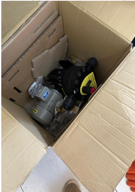
Figura TEC 2(B) – Bombas dosadoras de produtos químicos (eletromagnética e peristáltica).
