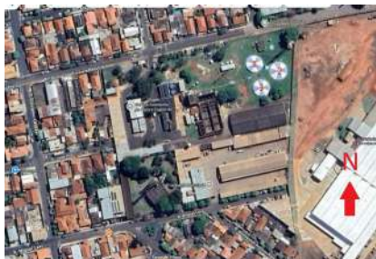
Foto 12 - Identificação dos três reservatórios de 1000 m3 existentes junto à ETA.
