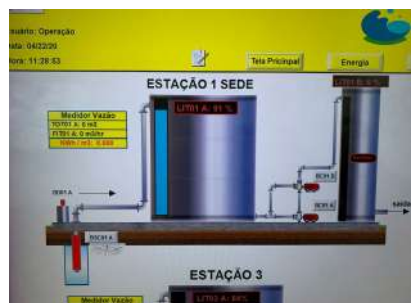
Foto 27 - Detalhes do reservatório 1 no CCO.
