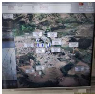
Foto 7 - Medição via telemetria do nível do reservatório
