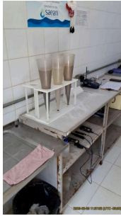
Foto 1 - Laboratório de análises físico-químicas. Na imagem é mostrado cones de Imhoff utilizados para determinação do volume de sólidos sedimentáveis, empregados na avaliação de sedimentos em amostras líquidas.
