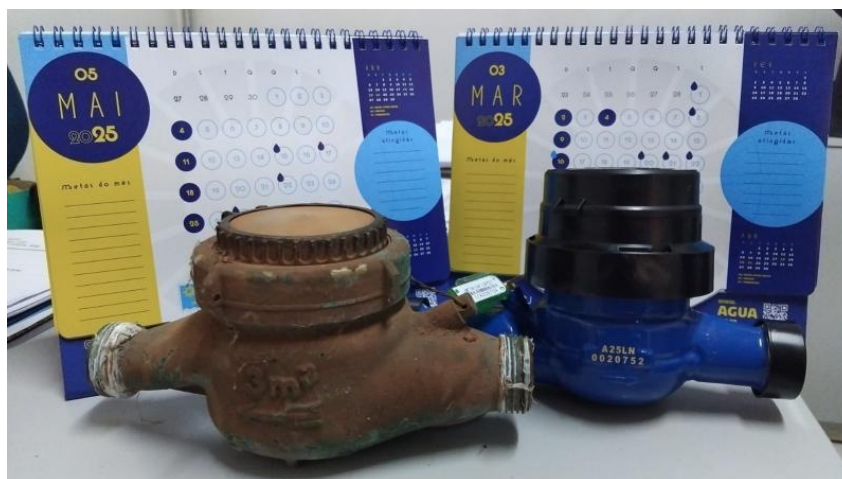
Figura TEC 4 – Troca de hidrômetros.
