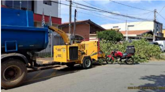
Foto 7 - Utilização de picador para diminuir o volume dos resíduos verdes.
