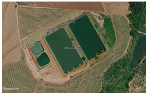
Foto 24 - Esquema dos fluxos de esgoto no tratamento por lagoas até o tanque de contato
