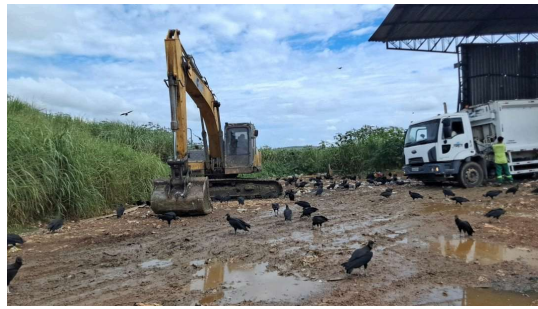
Foto 2 - Equipamento utilizado para carregamento das caçambas
