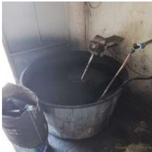
Foto 9 - Tanque de preparo do carvão ativado
