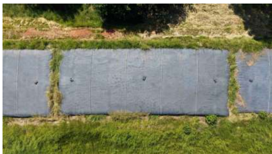
Foto 37 - Um dos geobags com lodo retirado das lagoas.
