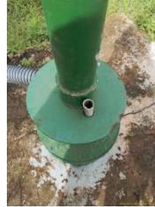
Foto 2 - Tubo de medição de nível.
