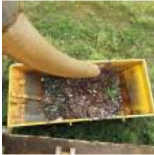
Foto 5 - Caçamba de descarte do material retirado do gradeamento.
