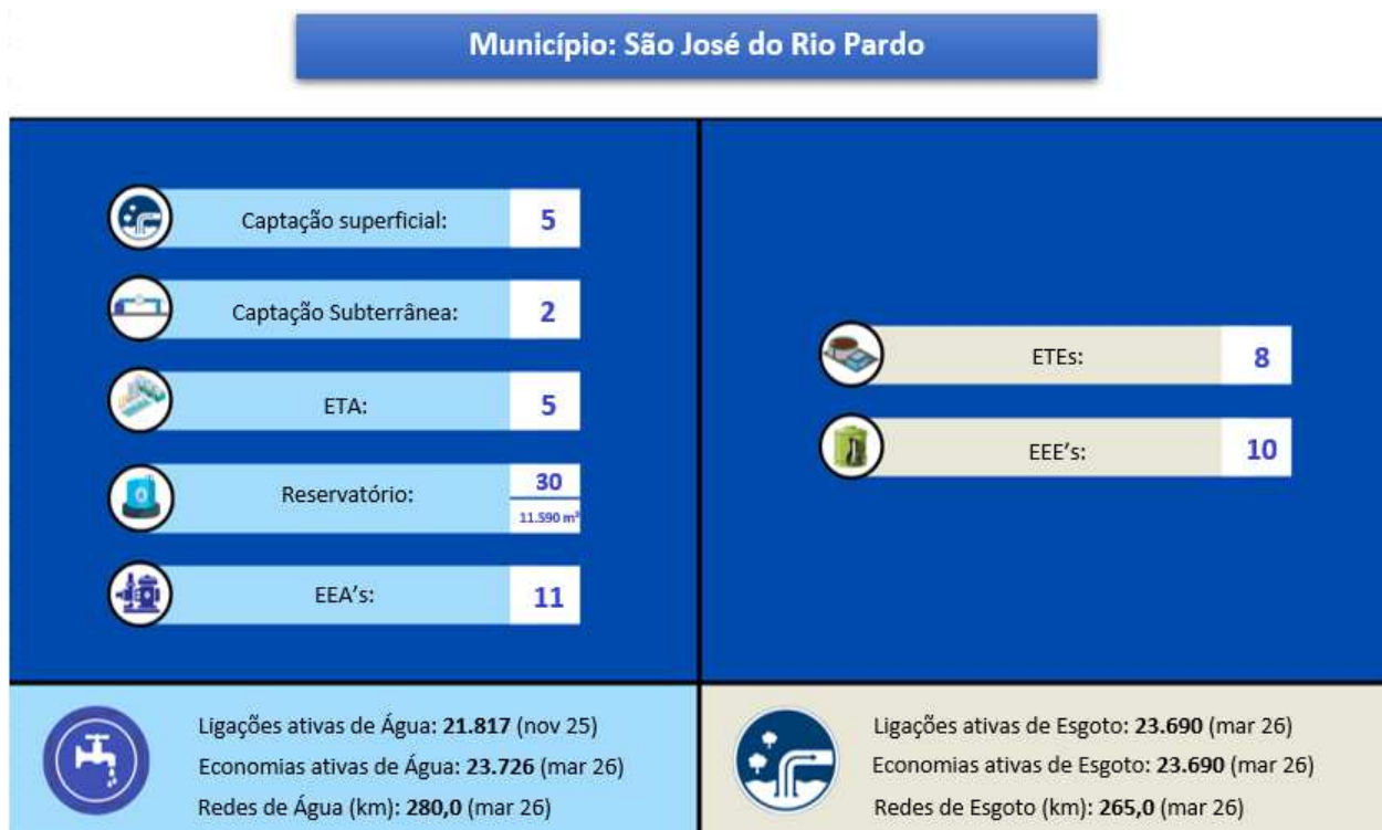
Quadro TEC 1 – Caracterização do SAA e SES em operação em São José do Rio Pardo.
