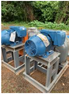
Foto 10 - Dois conjuntos moto bombas adquiridos pela prestadora.
