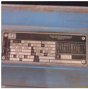
Foto 7 - Placa de especificações técnicas do motor do conjunto 1.
