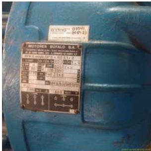
Foto 11 - Placa de especificações técnicas do motor do conjunto 2.
