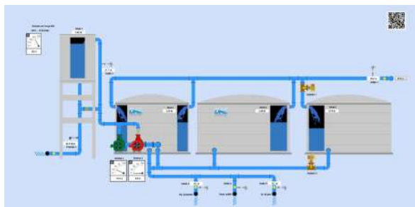
Foto 6 - Tela do sistema de telemetria do CR.
