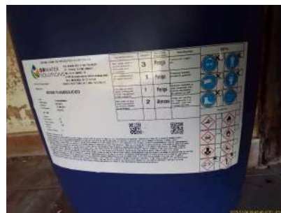
Foto 2 - Tanque de ácido fluossilícico, com destaque para a etiqueta informativa.
