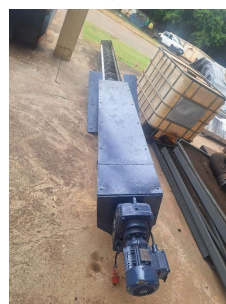
Foto 3 - Rosca transportadora aguardando
