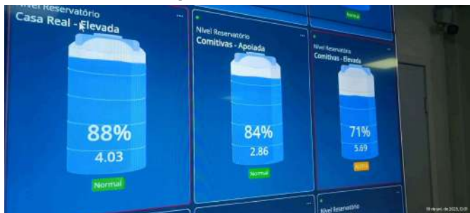
Foto 9 - Sistema de telemetria para os reservatórios do CR Comitivas.
