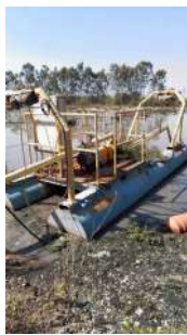
Foto 9 - Dragagem de lodo deteriorada e inoperante.
