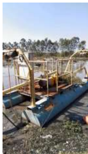
Foto 11 - Dragagem de lodo deteriorada e inoperante.
