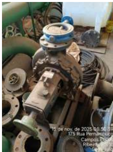
Foto 1 - Fotografia apresentada pelo prestador, referente a conjunto bomba e motor reservas, mantidos para atendimento à unidade fiscalizada.
