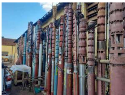
Foto 18 - Conjuntos de bomba reserva armazenados na unidade da Saerp na Rua Pernambuco.
