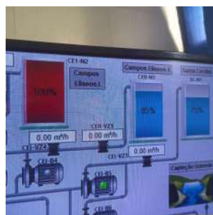
Foto 47 - Tela do sistema de telemetria dos reservatórios de Brotas.
