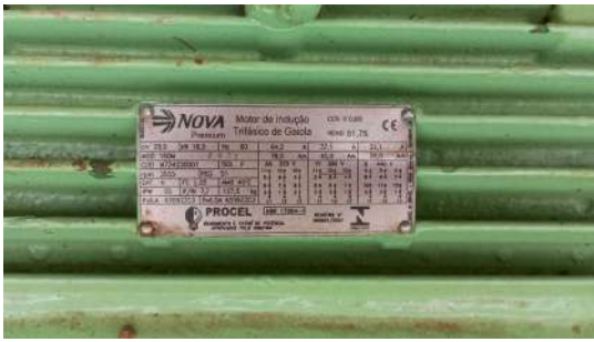
Foto 12 - Placa de especificações técnicas do motor de um dos equipamentos reservas.
