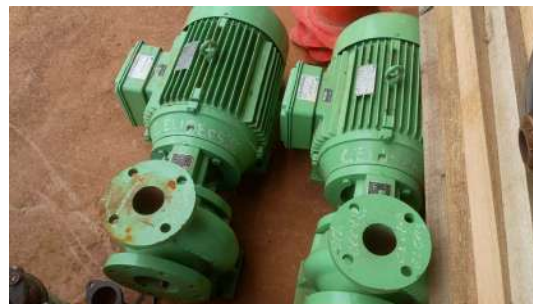
Foto 11 - Equipamentos reserva em estoque na ETA (os 2 equipamentos reservas podem ser utilizados nas duas EEAT do CR Campos Elísios 1).
