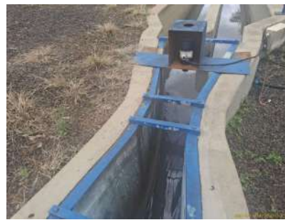
Foto 8 - Medição de vazão na entrada da lagoa aerada.
