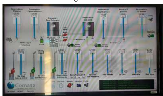
Foto 9 - Painel exibindo níveis dos reservatório no CCO do prestador.
