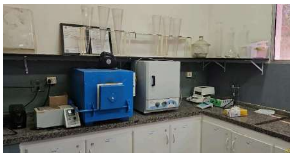
Foto 44 - Análise de sedimentáveis e pH são feitas na ETE (restante das análises são pela Quimiquali)
