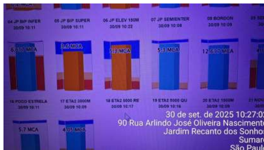
Foto 13 - Tela do CCO com o nível do reservatório.
