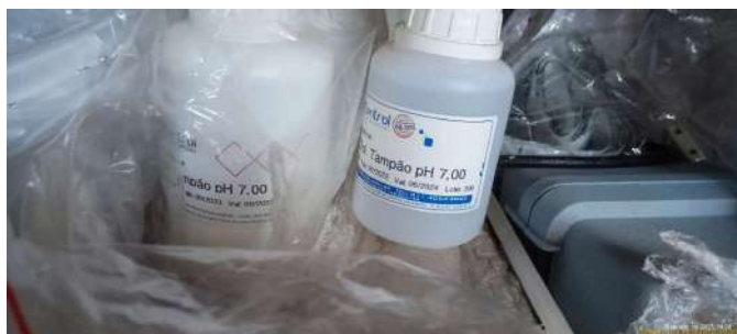
Foto 1 - Solução tampão com validade expirada.
