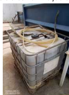
Foto 4 - Reservatório contendo PAC, com rachaduras e buraco na parte superior.
