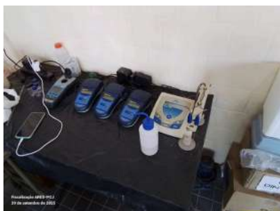
Foto 21 - Equipamentos para medição de pH, Fluoreto e turbidez.
