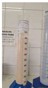
Foto 12 - Controle do geocalcio (teste de sedimentabilidade)
