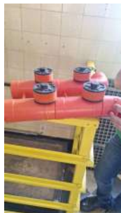
Foto 7 - Crepina de coleta de água filtrada no fundo
