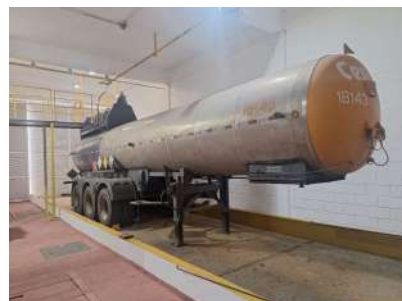
Foto 3 - Cilindro de cloro liquefeito
