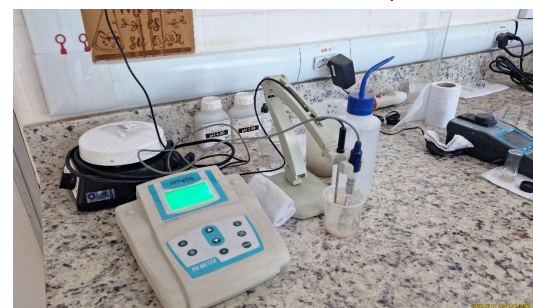
Foto 3 - Bancada do laboratório - análises básicas (pH, turbidez)
