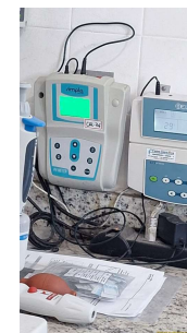
Foto 5 - Medida de pH antes e após dosagem de cal
