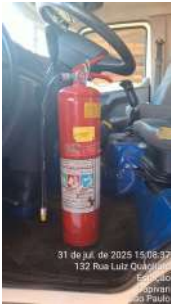
Foto 2 - Extintor do caminhão de apoio.
