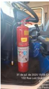
Foto 2 - Extintor do caminhão de apoio.
