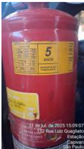
Foto 3 - Validade do extintor do caminhão de apoio.
