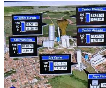
Foto 2 - Detalhe do nível do reservatório no CCO.
