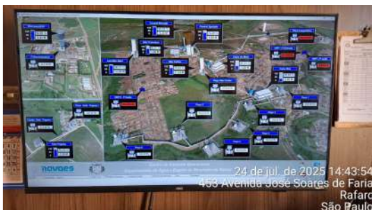
Foto 15 - CCO com os níveis dos reservatórios da cidade.
