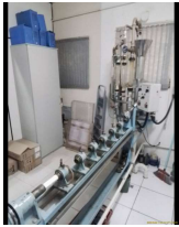
Foto 1 - Equipamento aferição hidrômetros
