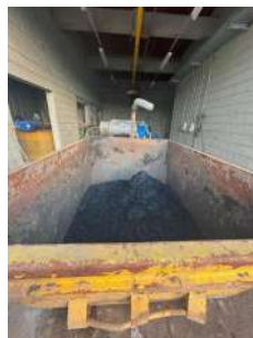
Foto 16 - Caçamba de lodo
