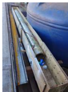
Foto 2 - Bombas reservas para poços no almoxarifado do prestador.
