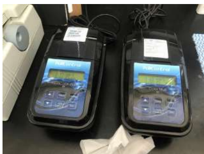
Foto 3 - Fotocolorímetro (Flúor e Multiparâmetros)
