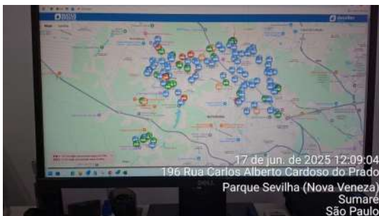
Foto 8 - Tela do CCO com o monitoramento de pressões da cidade.
