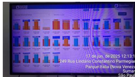
Foto 14 - CCO com os níveis dos reservatórios da cidade.
