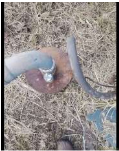
Foto 1 - Tubo para medição de nível.
