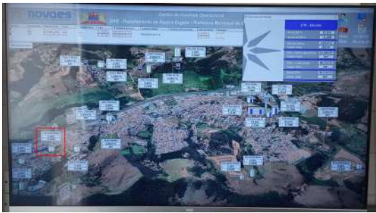
Foto 1 - Tela do supervisorio do sistema de telemetria instalado na ETA Sede. Na área destacada é possível observar que o Reservatório Travessa Belgica está representado no sistema, mas não está em funcionamento.
