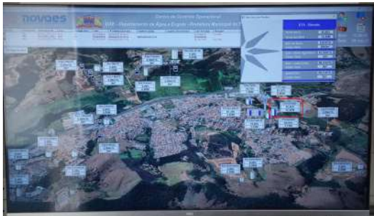
Foto 13 - O nível do reservatório é monitorando por telemetria.
