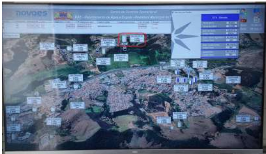
Foto 1 - Tela do supervisório do sistema de telemetria instalado na ETA Sede. Na área destacada é possível observar que o Reservatório Vale do Sol está representado no sistema, mas não está em funcionamento.
