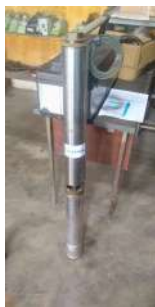
Foto 11 - Bomba reserva do poço armazenada no almoxarifado da Sede.
