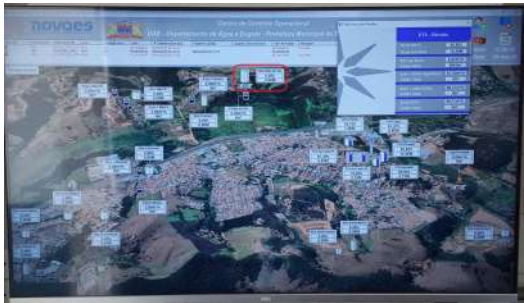
Foto 1 - Tela do supervisor do sistema de telemetria instalado na ETA Sede. Na área destacada é possível observar que o Reservatório Vale do Sol está representado no sistema, mas não está em funcionamento.
