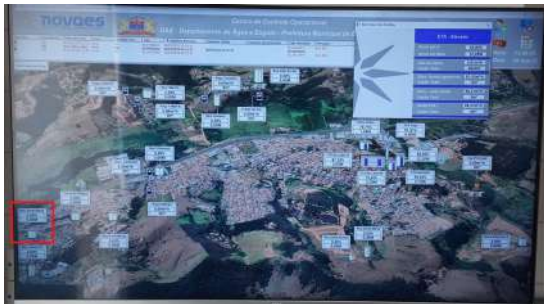
Foto 1 - Tela do supervisorio do sistema de telemetria instalado na ETA Sede. Na área destacada é possível observar que o Reservatório Santa Maria está representado no sistema, mas não está em funcionamento.
