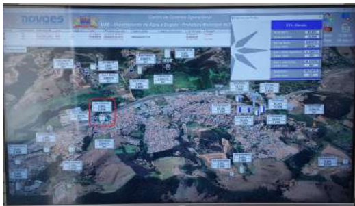
Foto 1 - Tela do supervisor do sistema de telemetria instalado na ETA Sede. Na área destacada é possível observar que o Reservatório Santos Dumont está representado no sistema, mas não está em funcionamento.
