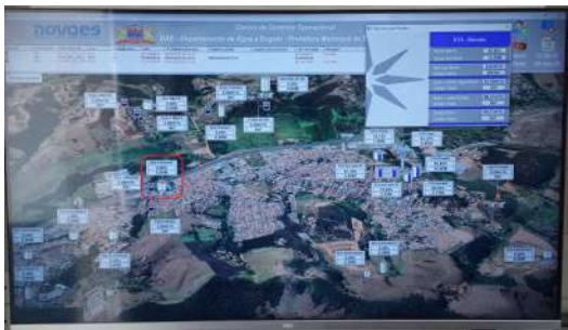
Foto 1 - Tela do supervisorio do sistema de telemetria instalado na ETA Sede. Na área destacada é possível observar que o Reservatório Santos Dumont está representado no sistema, mas não está em funcionamento.
