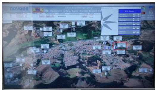
Foto 13 - O nível do reservatório é monitorado por telemetria.
