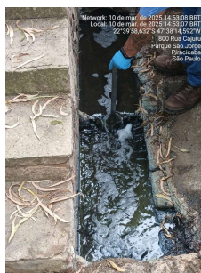
Foto 2 - Medição de vazão na saída documentada pelo prestador.
