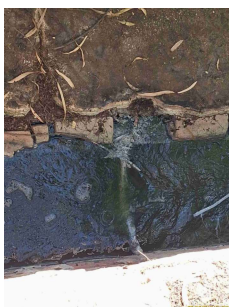
Foto 1 - Medição de vazão na saída - medidor afogado
