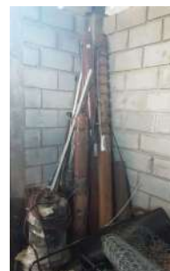
Foto 14 - Bombas reserva de poço armazenadas no almoxarifado.
