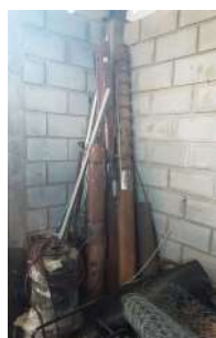
Foto 10 - Bombas reserva de poço armazenadas no almoxarifado.
