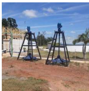
Foto 3 - Misturadores que serão instalados nos tanques para promover a agitação do lodo.
