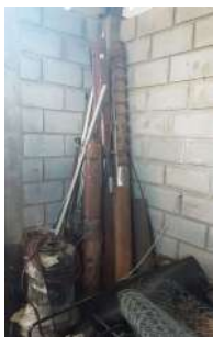
Foto 13 - Bombas reserva de poço armazenadas no almoxarifado.
