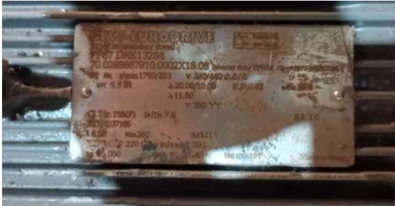
Foto 8 - Placa de especificações técnicas do motor de um dos conjuntos motobomba.
