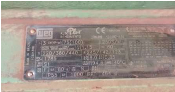
Foto 5 - Placa de especificações técnicas do motor do conjunto 1.
