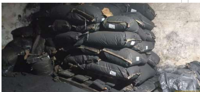
Foto 2 - Armazenamento de sacaria de carvão ativado, com sacos rasgados e carvão disperso pelo piso.
