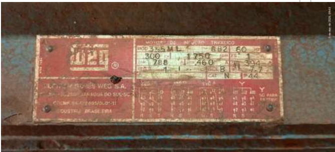
Foto 10 - Placa de especificações técnicas do motor do conjunto 03.
