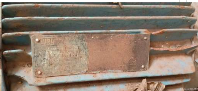
Foto 4 - Placa de especificações técnicas do motor do único conjunto motobomba em operação.
