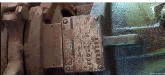
Foto 8 - Placa de especificações técnicas da bomba do conjunto motobomba 2.
