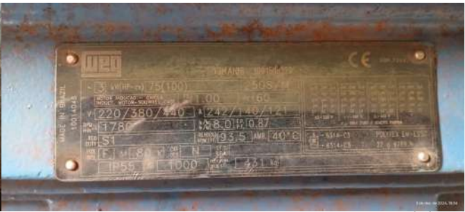
Foto 8 - Placa de especificações técnicas do motor do conjunto 2.
