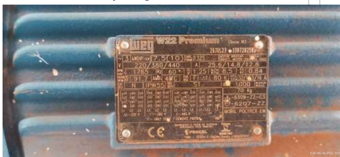
Foto 9 - Placa de especificações técnicas do motor de um dos conjuntos motobomba.
