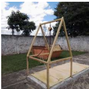
Foto 1 - Estrutura para içamento do cesto peneira.
