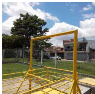
Foto 1 - Estrutura para içamento do cesto peneira.
