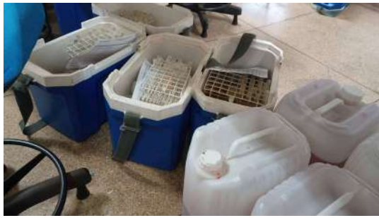
Foto 10 - Equipamentos para coleta e transporte das amostras de água.
