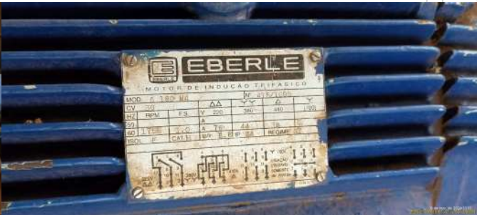
Foto 4 - Placa de especificações técnicas do motor do conjunto motobomba 01.
