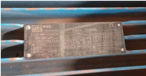
Foto 3 - Placa de especificações técnicas do motor do conjunto motobomba 2 Alto Alegre.
