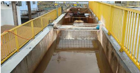
Foto 22 - Aplicação de hidróxido de cálcio e cloreto férrico.
