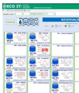
Foto 1 - Imagem do sistema de monitoramento dos níveis dos reservatórios. Este reservatório está identificado no sistema como "R07 - Jd. Paulista".
