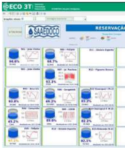
Foto 3 - Imagem do sistema de monitoramento dos níveis dos reservatórios. Este reservatório está identificado neste sistema como "R03 - Arco Íris".
