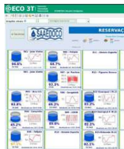
Foto 2 - Imagem do sistema de monitoramento dos níveis dos reservatórios. Este reservatório está identificado neste sistema como "R06 - Felipão".
