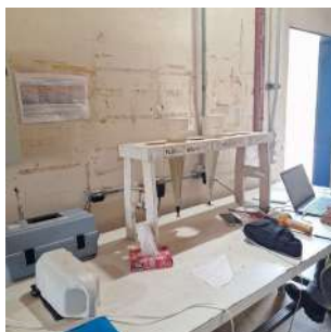
Foto 1 - Cone Imhoff - Sólidos sedimentáveis
