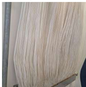
Foto 14 - Módulo de membranas
